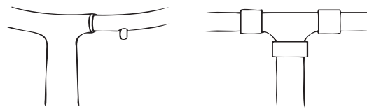
Abbildung: links: schematische Darstellung von Blei-, rechts: von Kupfer-/Stahlleitung
